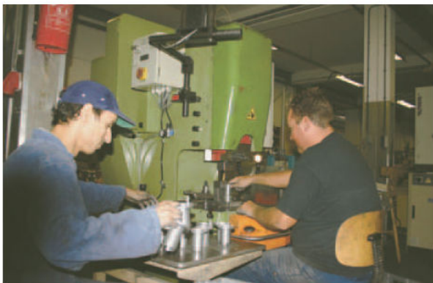
Naast de forceerrobot waarover we vorige week berichtten, wordt er ook nog geforceerd met forceerautomaten.
